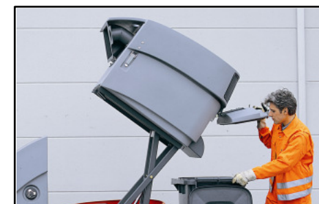
Svuotamento del contenitore di raccolta dietro pressione di un tasto
